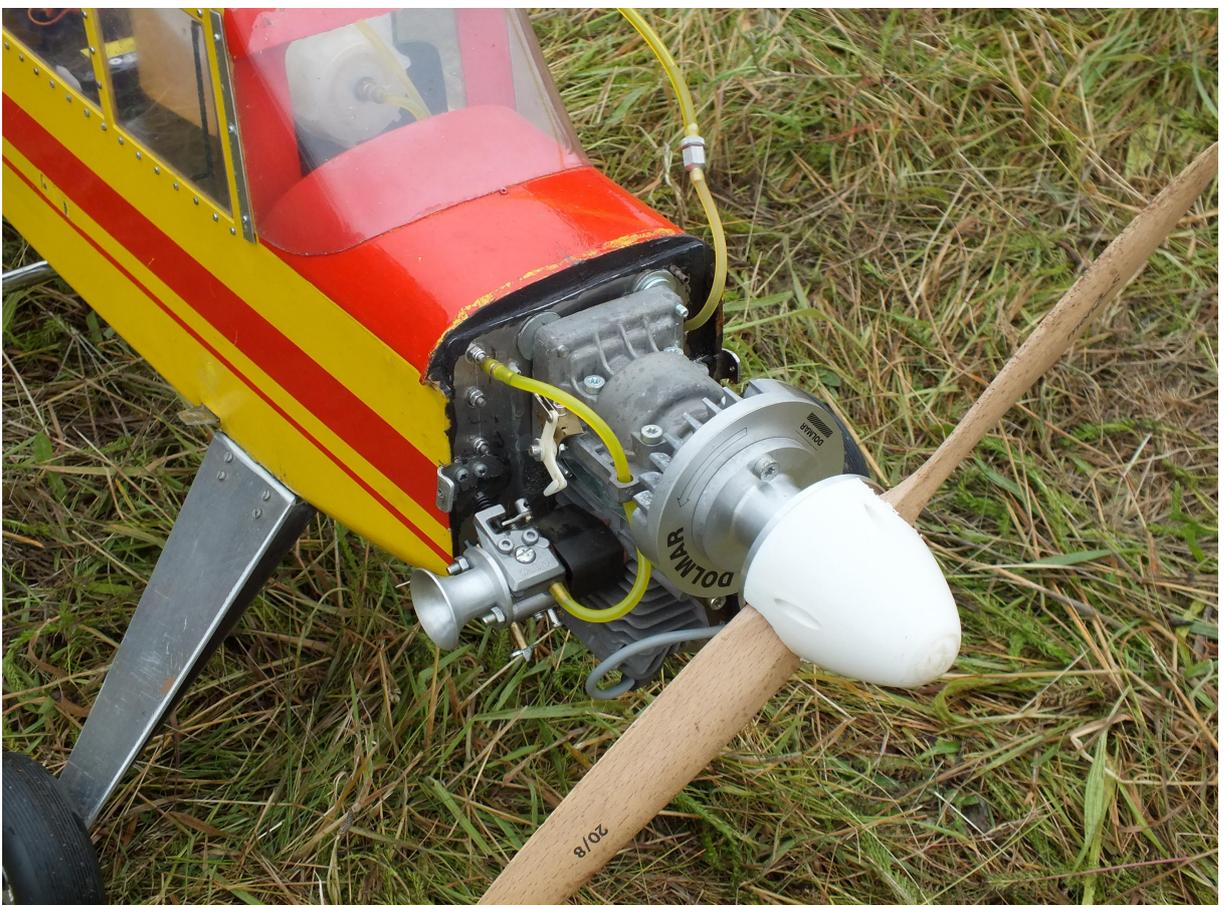
Benzinmotor und Vergaser mit Steuerung
